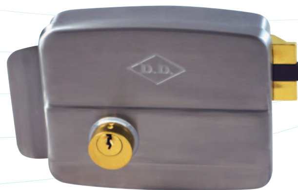
SDD62 DD 電鎖 正向電鎖 雙鎖心 24V AC/DC (可訂做12V ) 材質：白鐵 附 6支鑰匙
